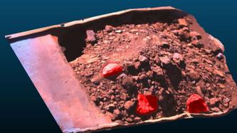
Deteção de blocos por TruckMetrics
