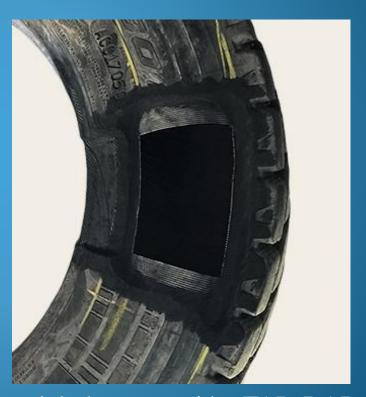
El material de reparación TAP RAP para costado tiene forma trapezoidal y ofrece la elasticidad y flexibilidad al área reparada.
