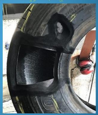
Los materiales y técnicas convencionales no permite efectuar reparaciones cerca del área de la Pestaña.
