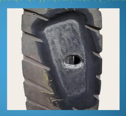
Esto se puede realizar de forma segura ya que el material de cordón de acero reforzado de reemplazo proporcionará resistencia y protección.
