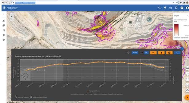
Acceso rápido a las últimas mediciones y detecciones de desplazamientos, mostradas junto al historial de mediciones a largo plazo.
