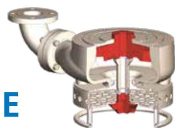
La bomba de juego carcasa-impulsor E Wet End tiene un impulsor tipo vórtice totalmente embutido, que permite el pasaje de sólidos grandes sin obstrucciones. También puede manejarse material sólido fibroso sin dificultad, debido al flujo natural del líquido a través de la carcasa de la bomba y al hecho de que el flujo está virtualmente aislado del impulsor (solo un 15 % del líquido bombeado está en contacto con el impulsor). Esta bomba es ideal para aplicaciones de bajo cizallamiento.
