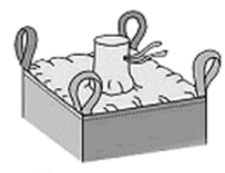
Boca de llenado
